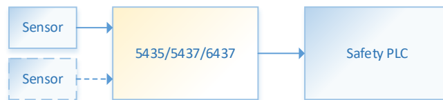
Abbildung 3: Ein Messumformer-Betrieb 1oo1
